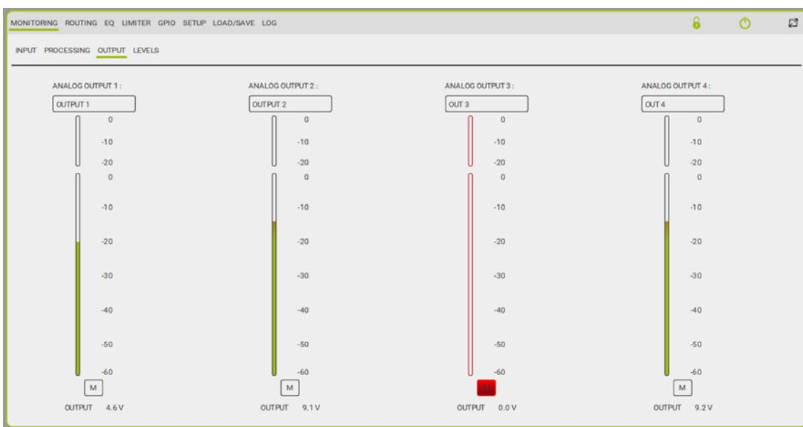
Desde la sección Output el usuario puede ver el nivel de las salidas del amplificador, el valor de la compresión y silenciar cada canal.
