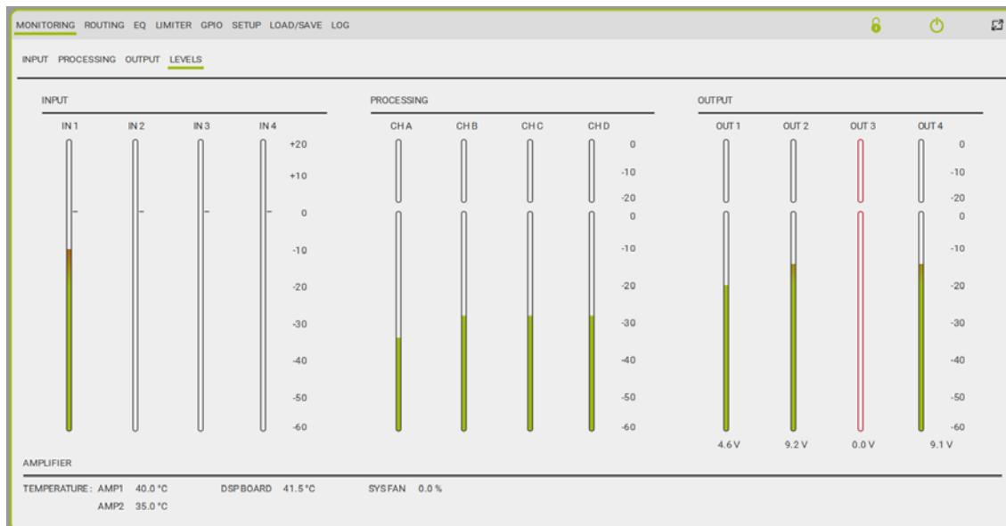
La sezione Levels fornisce informazioni circa il livello e l'ammontare della compressione dei segnali in ingresso, post processing e in uscita, della temperatura dell'amplificatore, del DSP e del sistema di raffreddamento.
