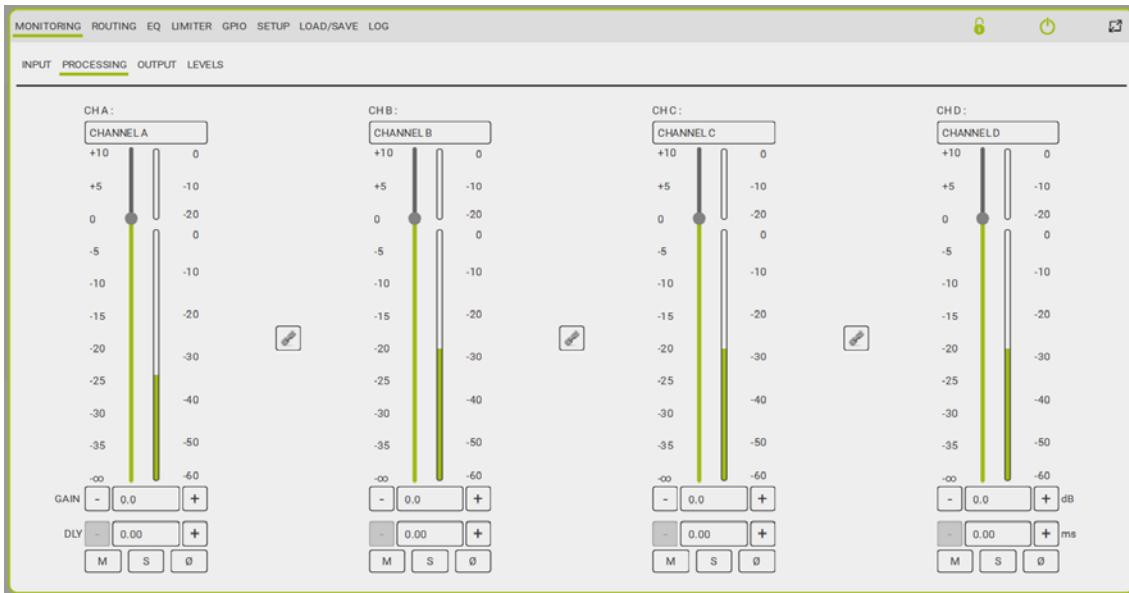
Von der Processing-Sektion aus ist es möglich, den Pegel und die Kompression der Signale in den Verarbeitungskanälen zu überwachen, auf Solo oder Mute zu schalten, die Polarität umzukehren, die Verzögerung einzustellen und die Kanäle A-B-, B-C und C-D zu verbinden. Der Link-Befehl wirkt sich auf die gesamte Prozessorkette aus. Die Kompressoranzeige bezieht sich auf den Kompressor, der im Bereich Limiter => Processing Channels aktiviert wird.
