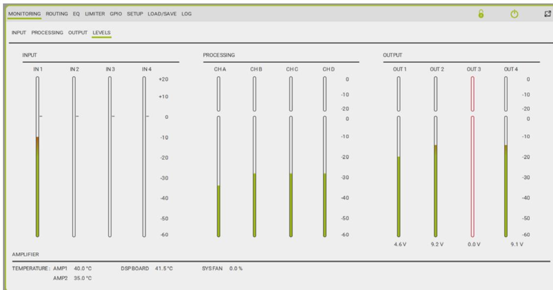
La section Levels donne des informations sur le niveau de compression des signaux en entrée, en post-processing et en sortie, sur la température de l'amplificateur, du DSP et du système de refroidissement.
