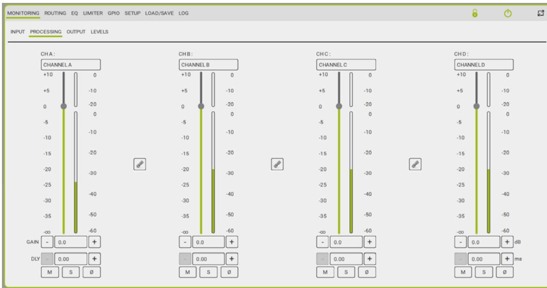
Desde la sección Processing es posible monitorizar el nivel y la compresión de las señales en los canales de procesamiento, poner en solo, silenciar, invertir la polaridad, introducir un retardo y enlazar los canales A-B, B-C y C-D. El mando Link actúa en toda la cadena del procesamiento. El limitador del compresor corresponde al compresor activado en la sección Limiter => Processing Channels.
