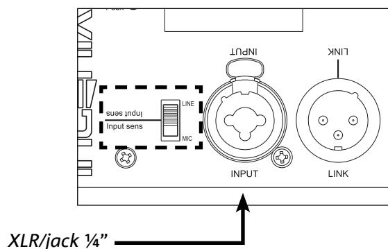
Per collegare 2 o più diffusori alla stessa sorgente audio, può essere utile, in diversi tipi di installazione, rilanciarne il segnale da un primo a un secondo e così via. Collegare innanzitutto una qualsiasi sorgente sonora nell'ingresso INPUT del primo diffusore. Collegare poi con un cavo bilanciato XLR l'uscita LINK del primo diffusore all'ingresso INPUT del secondo. Questa seconda operazione può essere poi ripetuta collegando diffusori per ottenere l'installazione più adeguata al contesto.
