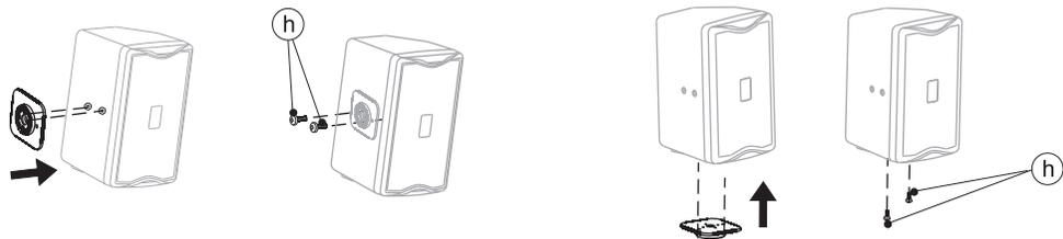
Fissare la staffa al diffusore tramite i due inserti presenti sul fianco
