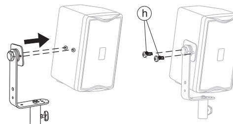
Fissare la staffa al diffusore tramite i due inserti presenti sul fianco
