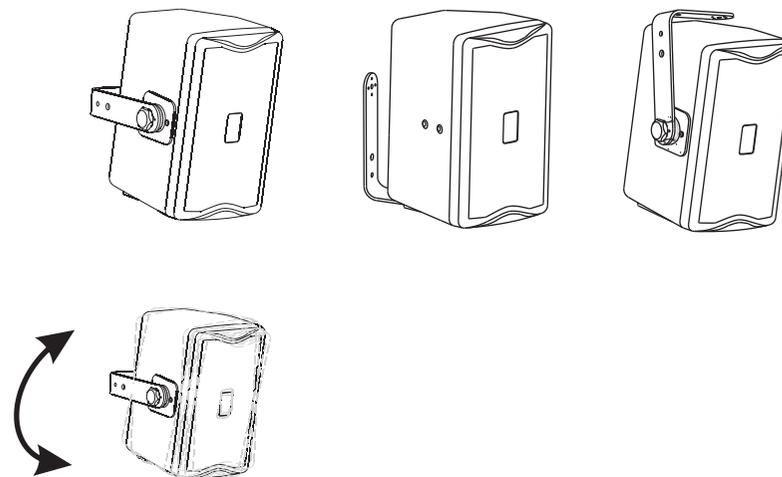
A seconda dell'angolo di copertura desiderato, sbloccare e ruotare il diffusore in corrispondenza degli ingranaggi dentellati, quindi serrare nuovamente.
