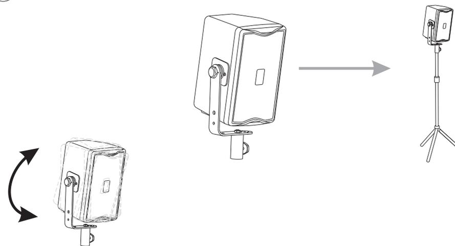
A seconda dell'angolo di copertura desiderato, sbloccare e ruotare il diffusore in corrispondenza degli ingranaggi dentellati, quindi serrare nuovamente.
