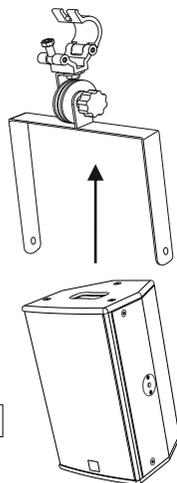
Posizionare il diffusore all'interno delle due aste laterali e fare combaciare i fori delle aste con i flypoints presenti sul diffusore
