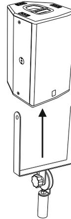
Posizionare il diffusore all'interno delle due aste laterali e fare combaciare i fori delle aste con i flypoints presenti sul diffusore
