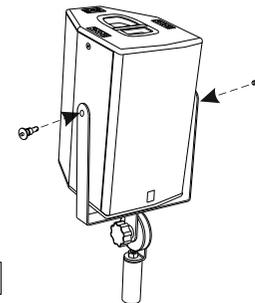
Bloccare il diffusore alla staffa tramite i 2 pins
