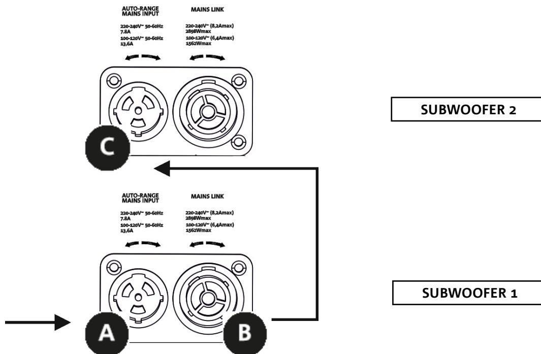
Nell'illustrazione sopra è mostrato un generico caso di collegamento in cui un subwoofer 1 è sotto al subwoofer 2. Utilizzare allo scopo cavi con connettori powerCON TRUE1® (è fornito un solo cavo in dotazione per l'alimentazione a confezione).
