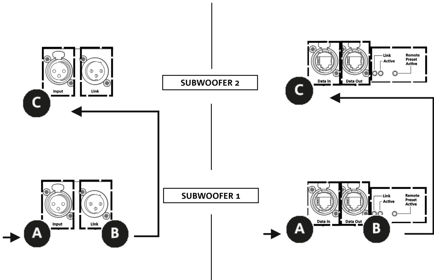
Nell'illustrazione sopra è mostrato un generico caso di collegamento in cui un subwoofer 1 è sotto al subwoofer 2, questa volta illustrando i collegamenti audio e di rete. Utilizzare allo scopo cavi non forniti, con connettori XLR (audio) e etherCON/RJ45 (rete). Per ulteriori informazioni sui tipi di cavi disponibili confrontare anche l'immagine nella pagina seguente.
