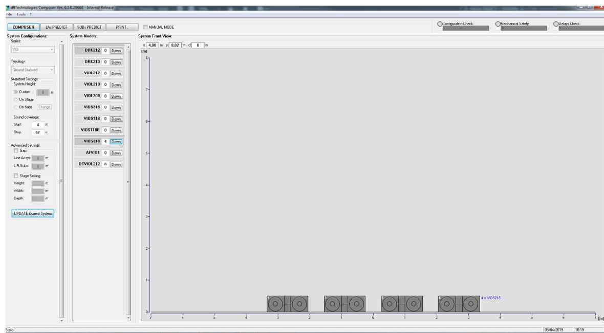
Per ottenere una simulazione predittiva, occorre inserire nella sezione COMPOSER tutti i parametri generali di progetto del sistema.
