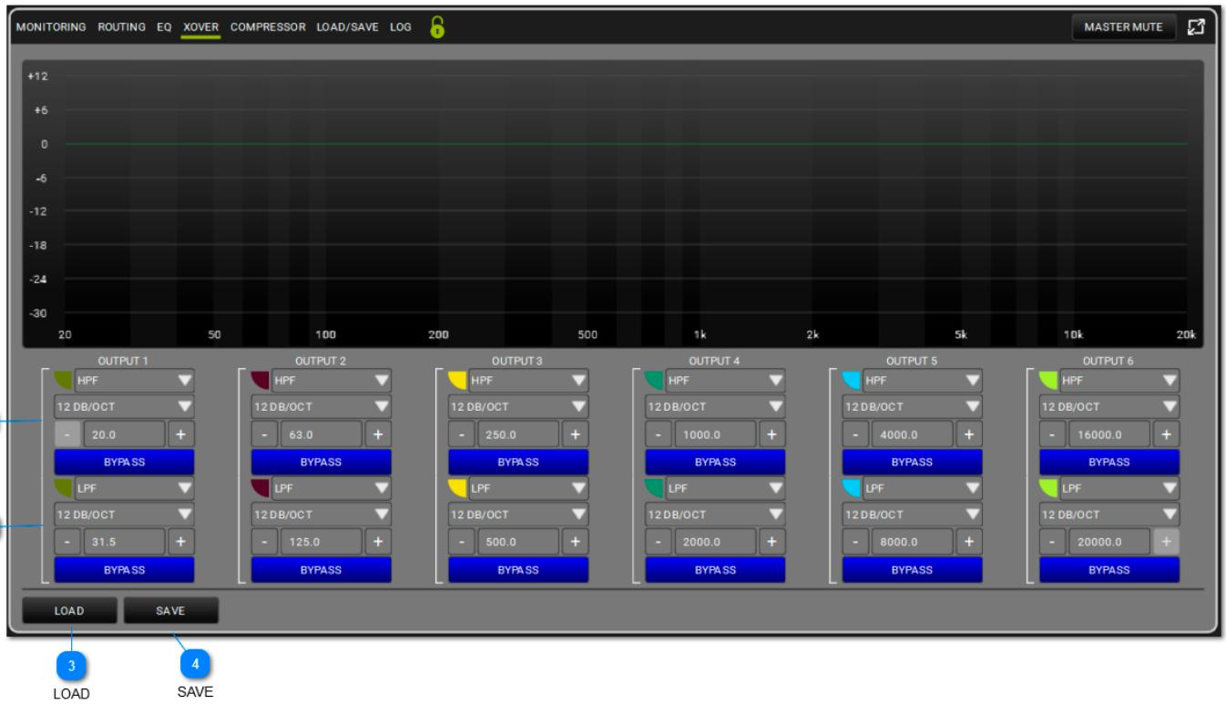
Per ogni canale output è possibile applicare un filtro HPF e LPF per modificare il crossover, selezionando le frequenze di taglio e le pendenze. Si può by-passare uno o più filtri per verificarne l'effetto, come rimuoverne uno o più in tempo reale e salvarne/caricarne i profili. Per una migliore visualizzazione si possono assegnare ad ogni filtro colori diversi.
