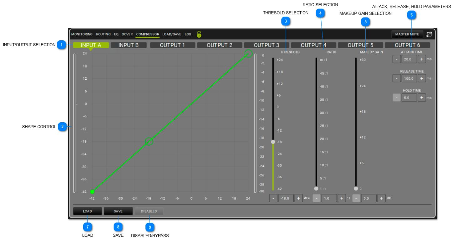
Ceci applique un compresseur au canal sélectionné. La forme (en termes de seuil et de rapport) peut être contrôlée soit sur le graphique ou à travers les curseurs.
