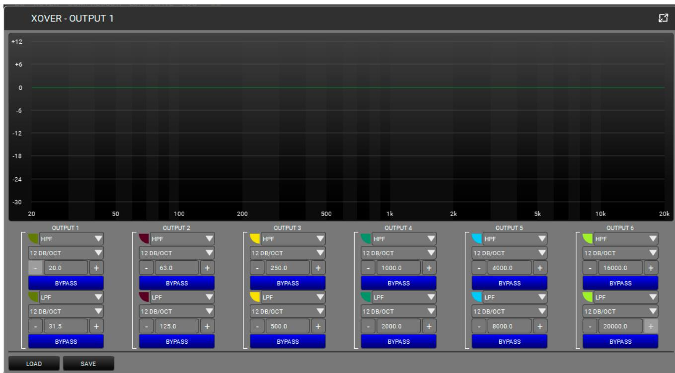
Permite configurar un filtro paso alto HPF y un filtro baso bajo LPF para cada canal de salida, seleccionando las frecuencias y las pendientes. Cada uno de estos filtros puede desactivarse para comparar la señal con o sin él. También se pueden guardar o cargar preajustes. Además, se le puede asignar un color a cada filtro para una visualización más clara.
