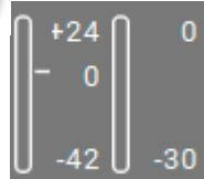
Hier wird der Signalpegel des ausgewählten Eingangs angezeigt.
