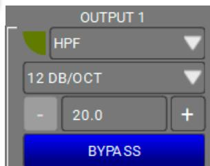
Vous pouvez choisir entre filtre High Pass ou Low Pass ainsi que choisir la pente (12/24/48 dB/OCT) et la fréquence de coupure.
