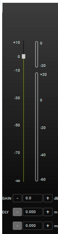
El PANEL NIVEL/DELAY permite visualizar y controlar de forma inmediata los niveles, la ganancia y el delay de un grupo.
