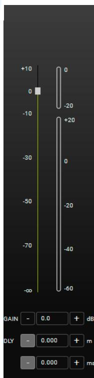
In dem FENSTER LEVEL/DELAY können Sie sofort die Pegel, Verstärkung und Verzögerung in einer Gruppe anzeigen und steuern.
