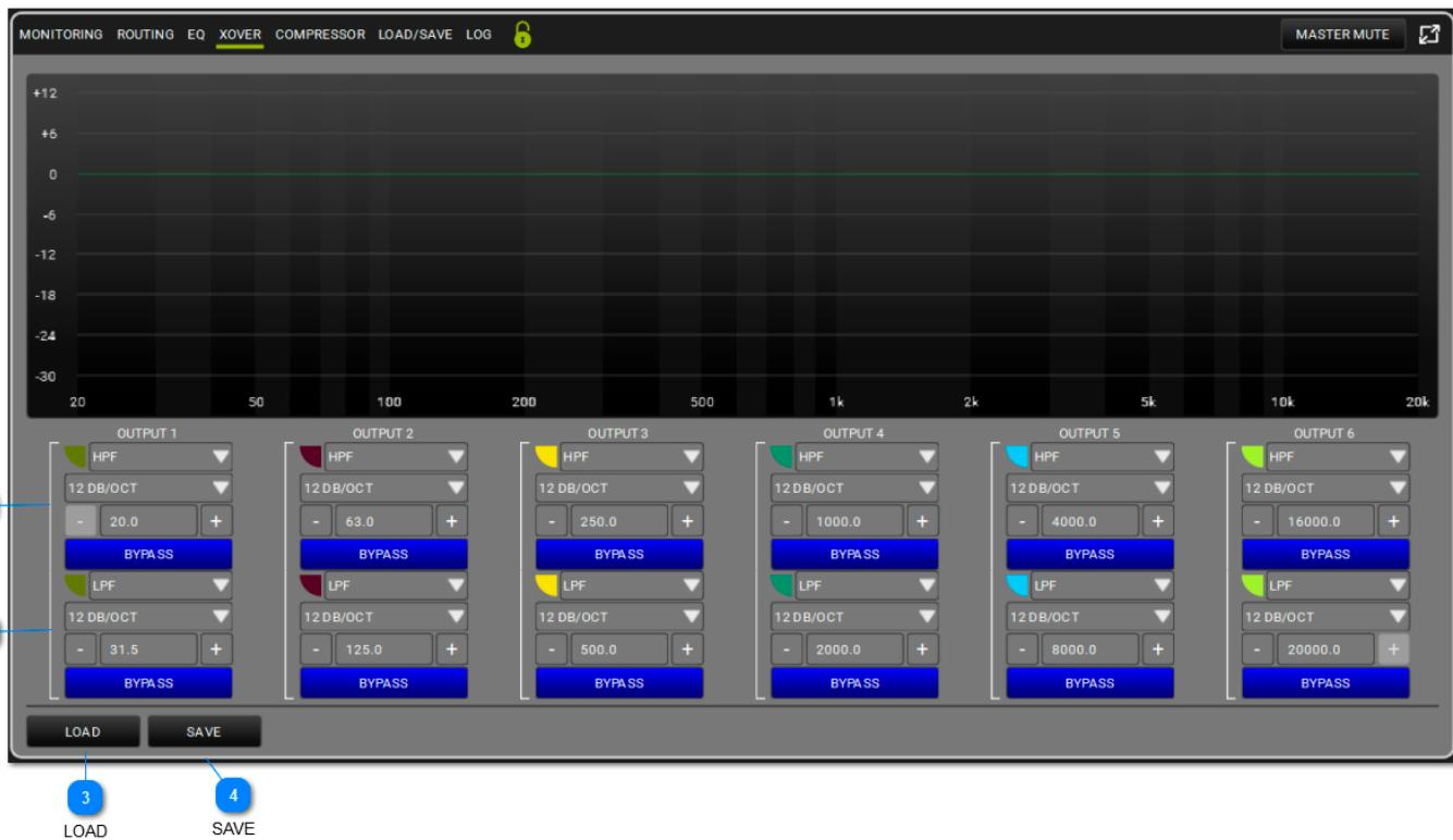
Vous pouvez régler pour chaque canal de sortie un filtre HPF et un filtre LPF pour donner forme au point de croisement, en choisissant les fréquences et les pentes. Chaque filtre peut être contourné pour apprécier le son avec ou sans le filtre. Vous pouvez également sauvegarder ou charger des prérglages. Veuillez noter que vous pouvez assigner une couleur à chaque filtre pour obtenir une visualisation plus claire.
