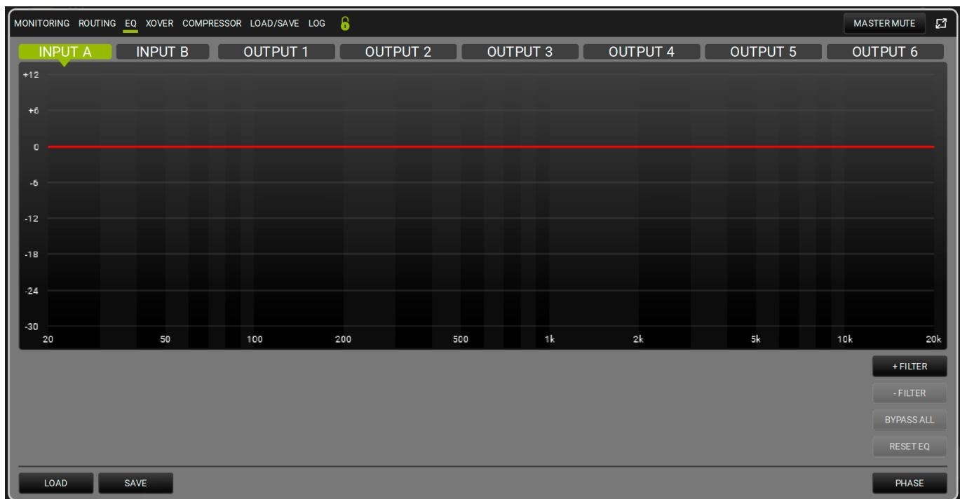
In questa schermata è possibile controllare l'equalizzazione di tutti gli input e output. Ad ogni canale è possibile applicare fino a 12 filtri.
