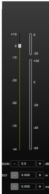
La FENÊTRE LEVEL/DELAY (NIVEAU/DÉLAI) vous permet de voir et de contrôler immédiatement les niveaux, le gain et le délai d'un groupe.
