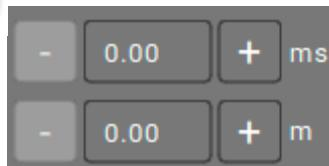
Permite seleccionar un delay en ms (rango: 0.00 - 72.90) o m (rango: 0.00 - 25.02).
