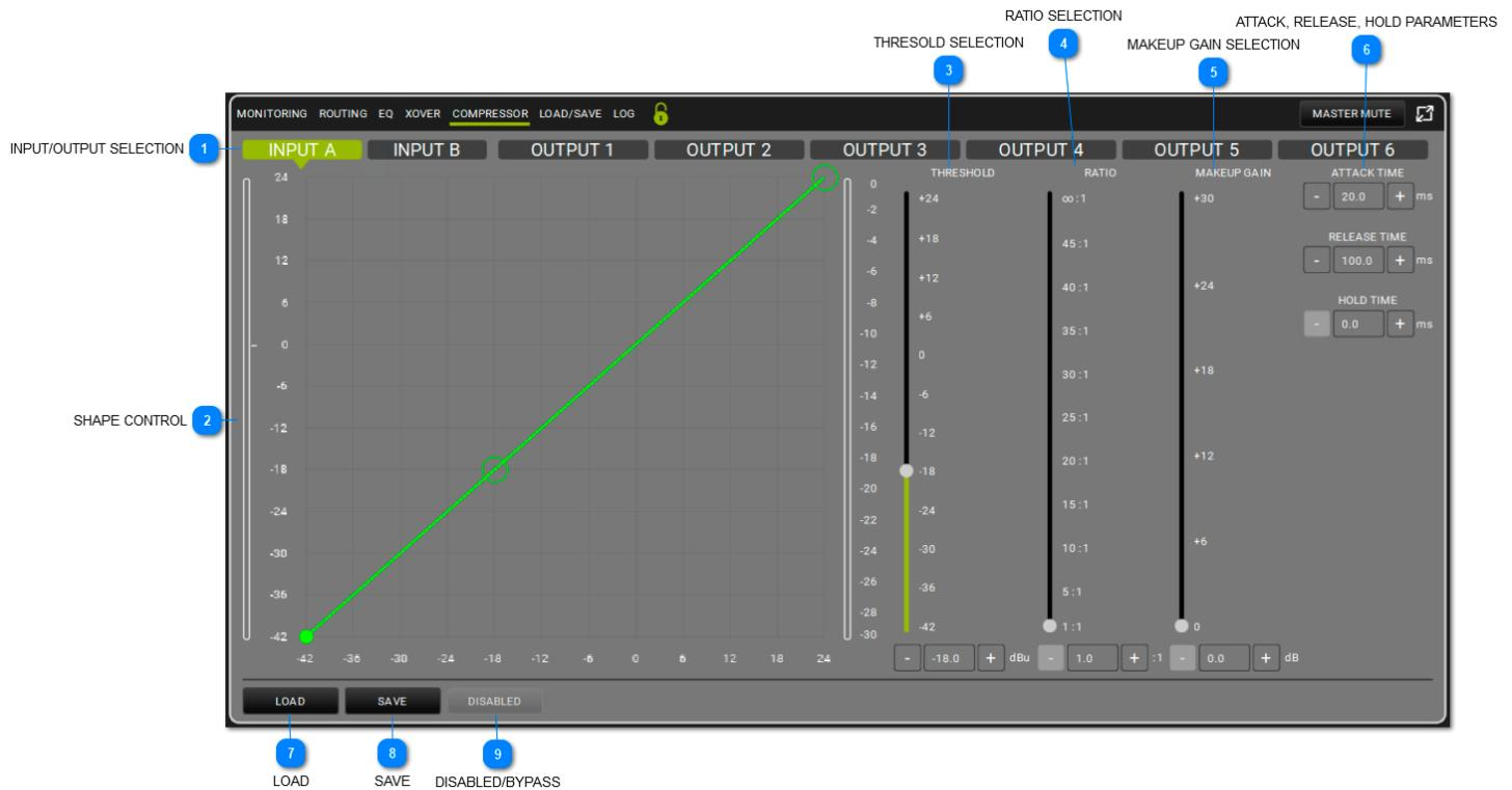
Applica un compressore all'input. La soglia (Threshold) e li rapporto (Ratio) possono essere controllati in modo grafico e tramite cursori. La soglia definisce il livello minimo di intervento (con la sua forma specifica). Si può configurare un attacco (range: 1-200 ms), un rilascio (range: 1-1000 ms), oltre a un Hold (0.0-1000 ms). Si può by-passare il compressore per verificarne l'effetto.
