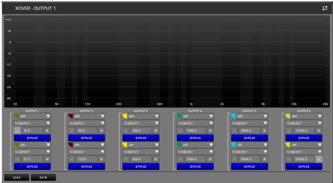
Si può impostare un HPF e un LPF per ogni canale di output, selezionando frequenze di taglio e pendenze. Ogni filtro può essere immediatamente by-passato per verificarne l'effetto. Si possono salvare o caricare preset precedenti. Per una migliore visualizzazione si possono assegnare ad ogni filtro colori diversi.
