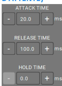
Applique les paramètres pré-sélectionnés d'attaque, de relâchement et de maintien du compresseur
