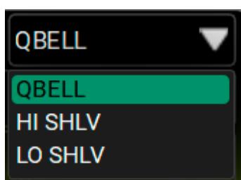
Este menú aplica un filtro al canal seleccionado (ecualizador paramétrico PEQ, Hi Shelf o Low Shelf, como se muestra arriba). Se pueden añadir hasta 12 ecualizadores en la banda de frecuencia entre 20 y 20.000 Hz. Su forma se puede ajustar utilizando la interfaz gráfica o modificando los siguientes parámetros: Q (rango: 0.511 - 72.134), ganancia GAIN (rango: -30.0 - 12.0).
