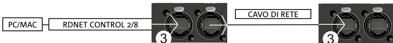
Per il controllo remoto, collegare il Data Input del primo speaker al controller hardware (RDNet Control 2 o RDNet Control 8) con cavi equipaggiati con connettori ethernCON. Quindi connettere il Data Output del primo speaker al Data Input del secondo e così via. Una volta accesi i monitor, i LED "Link" indicheranno l'avvenuto collegamento. Gli altri LED "Active" inizieranno a lampeggiare in presenza di traffico dati.
