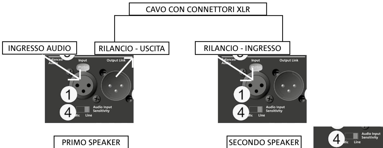
E' possibile rilanciare un segnale audio connettendo l'uscita Output Link all'ingresso Input di una seconda VIO X. Nel secondo speaker, Audio Input Sensitivity deve essere sulla posizione "Line".
