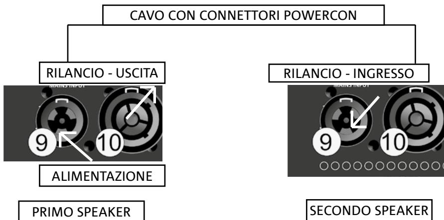
E' possibile rilanciare l'alimentazione ad altri moduli di VIO X collegando l'uscita Mains Link del primo speaker all'ingresso del secondo e così via. E' possibile ripetere questo tipo di collegamento fino al raggiungimento della massima corrente ammessa e indicata dal connettore MAINS LINK del primo speaker.
