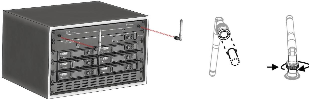
a) Setzen Sie die mitgelieferten Antennen an der Vorderseite in die entsprechenden A6W BNC-Anschlüsse ein und schrauben Sie sie fest.
