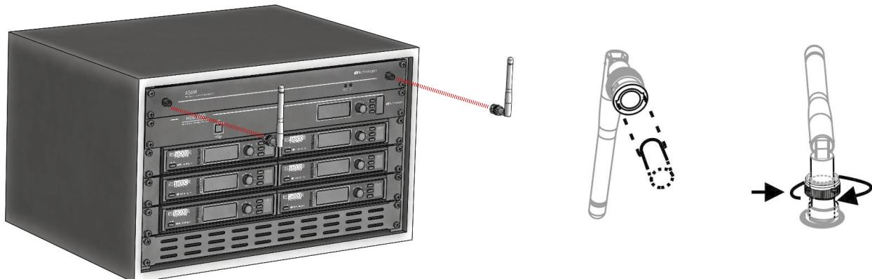
a) sul lato frontale, inserire ed avvitare le antenne in dotazione negli appositi connettori BNC di A6W.
