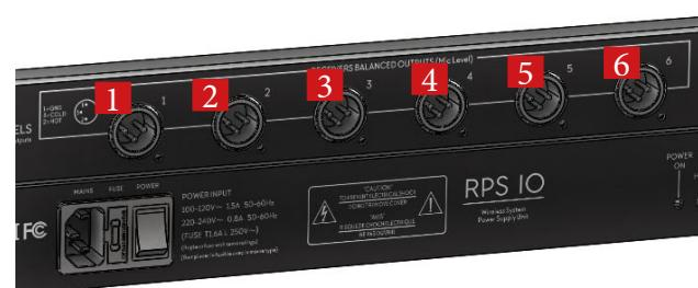
**Nota:** Las salidas audio son por defecto de nivel microfónico. Para cambiar a "Line" las salidas del sistema, consultar el capítulo "Actualización del firmware" que muestra el acceso a la parte interior del rack, permitido solo en estos casos y reservado solo a personal experto.
