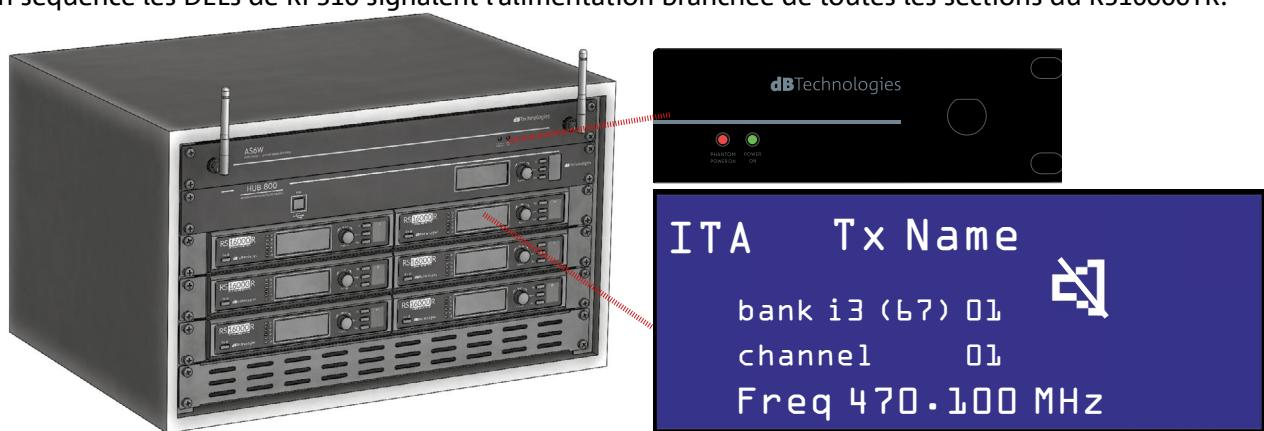
c) sur le panneau avant les DELs du module AS6W signalent l'alimentation des antennes. Les afficheurs s'allument. En particulier, ceux des récepteurs RS16000R visualisent une page similaire à celle dans la figure.
