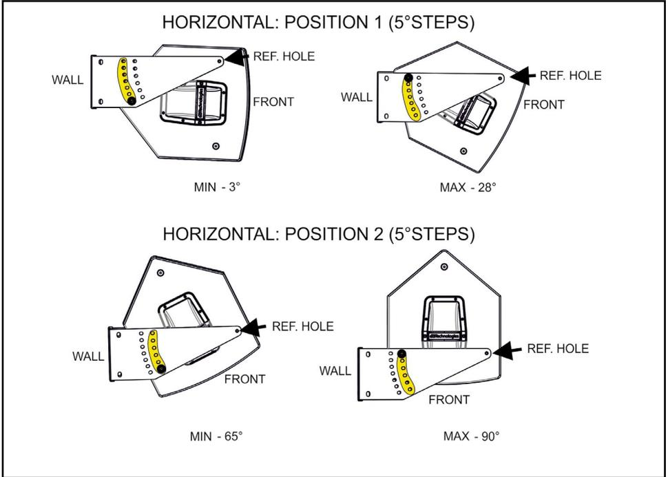
Sono previste 2 posizioni principali di montaggio. Un foro di fissaggio per lato (REF. HOLE) è lo stesso per entrambe. Il secondo si sceglie in base all'angolo da ottenere. In figura sono mostrate le 2 posizioni e gli angoli estremi ottenibili. Lo step ad ogni foro è di 5°.
