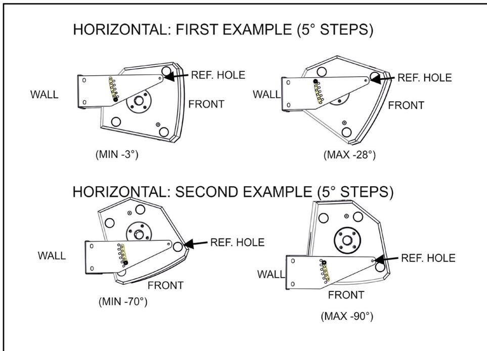
Sono previste 2 posizioni principali di montaggio. Un foro di fissaggio (REF. HOLE) è lo stesso per entrambe. Il secondo si sceglie in base all'angolo da ottenere. In figura sono mostrate le 2 posizioni e gli angoli estremi ottenibili. Lo step ad ogni foro è di 5°.
