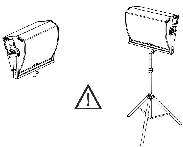
Der SA-WT Stabivadapter ermöglicht die Montage eines VIO W15T Lautsprechers auf einem Stabiv (D=35 mm) oder auf einem Subwoofer mithilfe einer Stange (D=35 mm). Die maximal zulässige Höhe der Basis des Adapters über dem Boden beträgt 150 cm.
