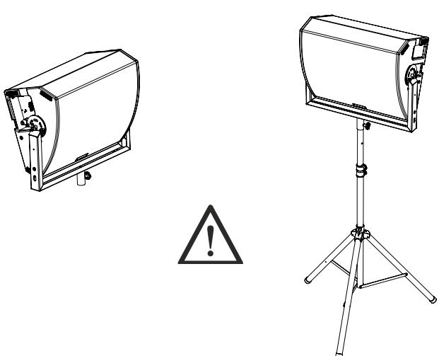
L'accessoire SA-WT permet d'installer un moniteur VIO W15T sur un trépied (D=35 mm) ou sur un subwoofer à l'aide d'une barre (D=35 mm). La hauteur maximale autorisée de la base de l'adaptateur par rapport au sol est de 150 cm.
