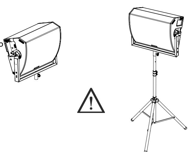
El accesorio SA-WT permite instalar un altavoz VIO W15T en un trípode (D=35 mm) o en un subwoofer utilizando una barra (D=35 mm). La altura máxima permitida de la base del adaptador sobre el suelo es de 150 cm.
