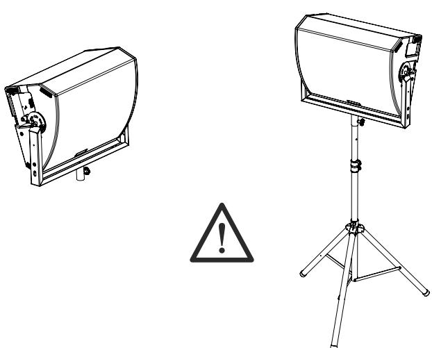
E' possibile installare diffusori VIO W15T su treppiede (D=35mm) o su subwoofer palo (D=35mm) tramite l'adattatore SA-WT. L'altezza massima consentita tra la base dell'adattatore e terra è di 150 cm.
