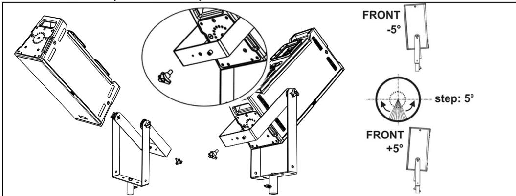
1. Operare in due persone. Allentare i volantini B, ruotare la staffa snodata per il montaggio dello speaker, quindi riavvitarli. Fissare VIO-X206/IS26T utilizzando il volantino di fissaggio C.
