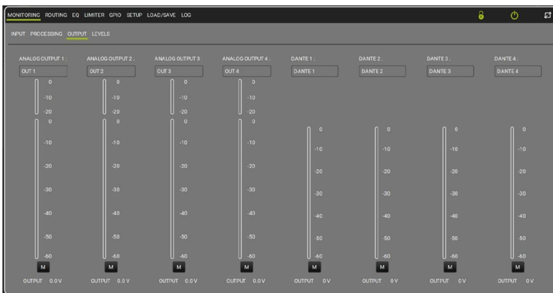
Dalla sezione Output l'utente può visualizzare il livello delle uscite dell'amplificatore, l'ammontare della compressione e mettere in muto i singoli canali.
