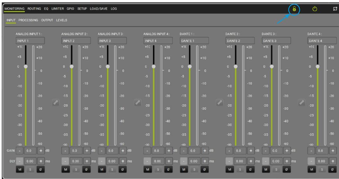
Pour accéder à la fenêtre Lock Device, appuyer sur le cadenas en haut et à droite dans la page principale d'Aurora. Il permet de bloquer/débloquer les pages d'Aurora.
