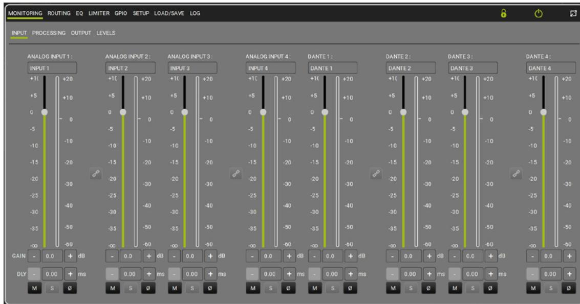
Von der Input-Sektion aus ist es möglich, den Pegel der Eingangssignale zu überwachen, Gain und Verzögerungszeit einzustellen, auf Solo oder Mute zu schalten, die Polarität umzukehren und die Kanäle 1-2 und 3-4 miteinander zu verbinden. Der Link-Befehl wirkt sich auf die gesamte Prozessorkette aus. Standardmäßig ist Gain auf 0 dB, Delay auf 0 ms eingestellt und die Verbindung zwischen den Kanälen ist nicht aktiv.
