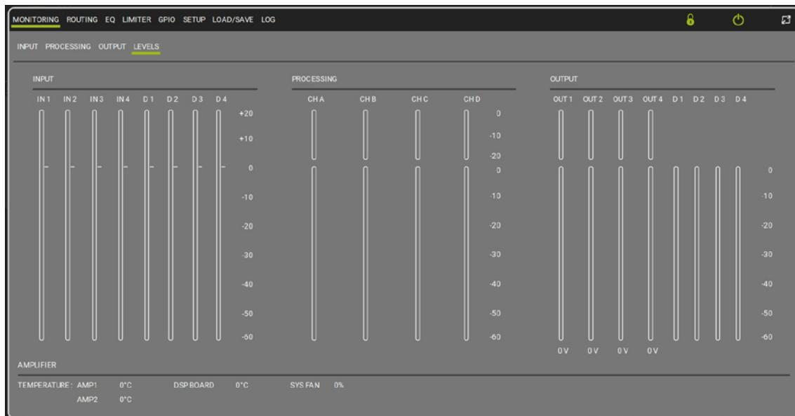
La sección Levels proporciona información acerca del nivel y la cantidad de compresión de las señales de entrada, post-procesamiento y de salida, la temperatura del amplificador, el DSP y el sistema de refrigeración.
