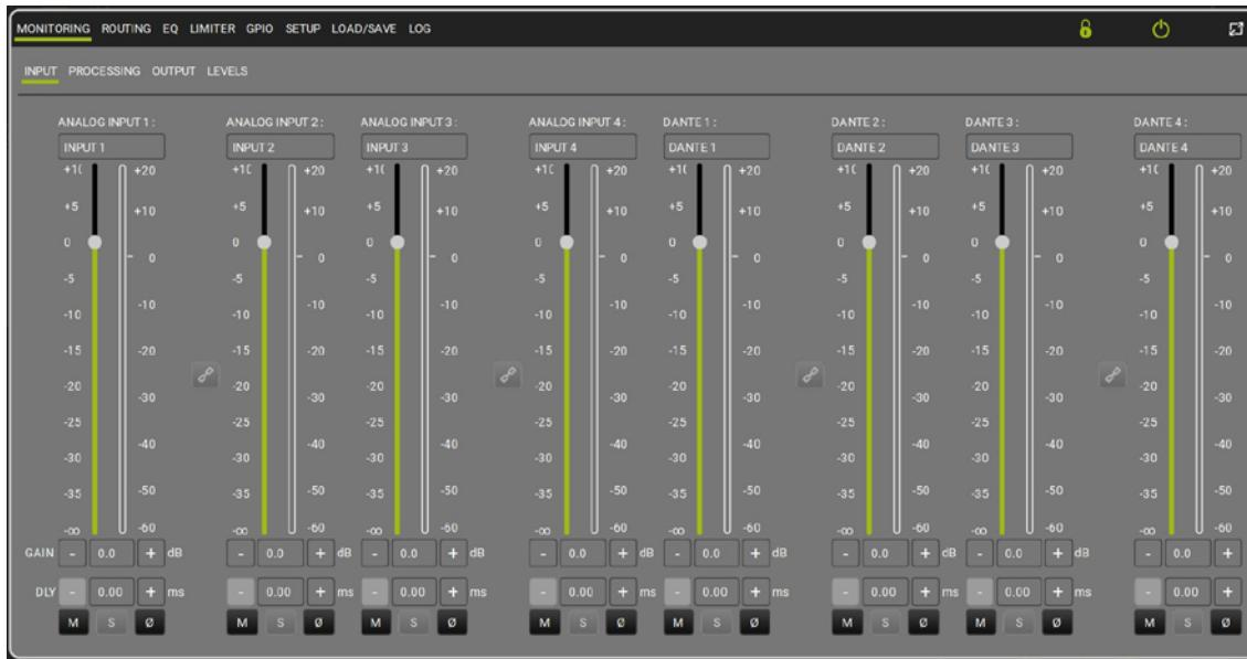
Desde la sección Input es posible monitorizar el nivel de las señales de entrada, configurar ganancia y tiempo de retardo, poner en solo, silenciar, invertir la polaridad y enlazar entre sí los canales 1-2 y 3-4. El mando Link actúa en toda la cadena de procesamiento.
