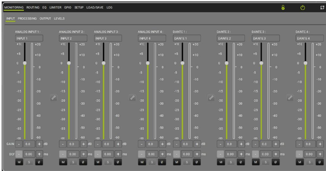
La section Input permet de superviser le niveau des signaux en entrée, de définir le gain et le retard, de mettre en solo, en mute, d'inverser la polarité et de mettre en link les canaux 1-2 et 3-4. La commande Link intervient sur toute la chaîne de traitement.
