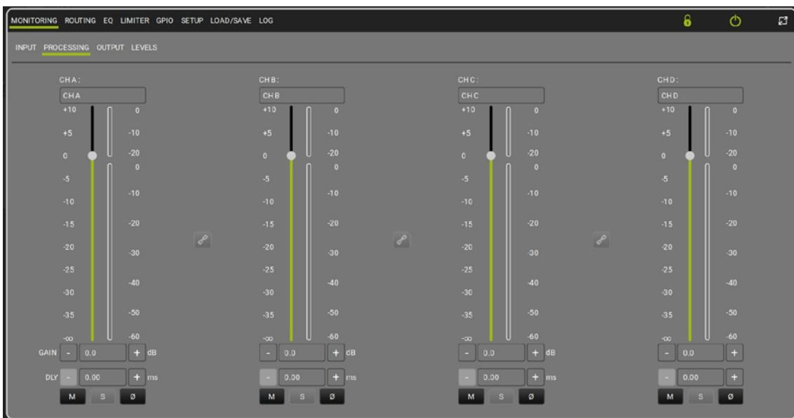
La section Processing permet de monitorer le niveau et la compression des signaux dans les canaux de traitement, de mettre en solo, en mute, d'inverser la polarité, de définir un retard et de mettre en link les canaux A-B, B-C et C-D. La commande Link gère toute la chaîne de traitement. Le vumètre du compresseur se réfère au compresseur activé dans la section Limiter => Processing Channels.
