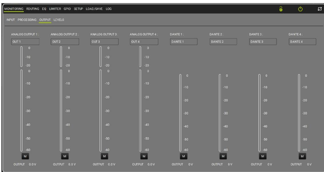
Desde la sección Output el usuario puede ver el nivel de las salidas del amplificador, la cantidad de compresión y silenciar cada canal.
