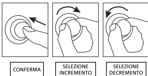
Esempi di utilizzo del push rotary encoder
